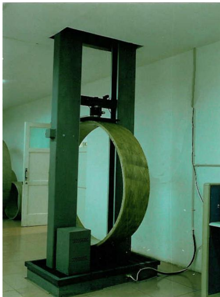
管道刚度试验
