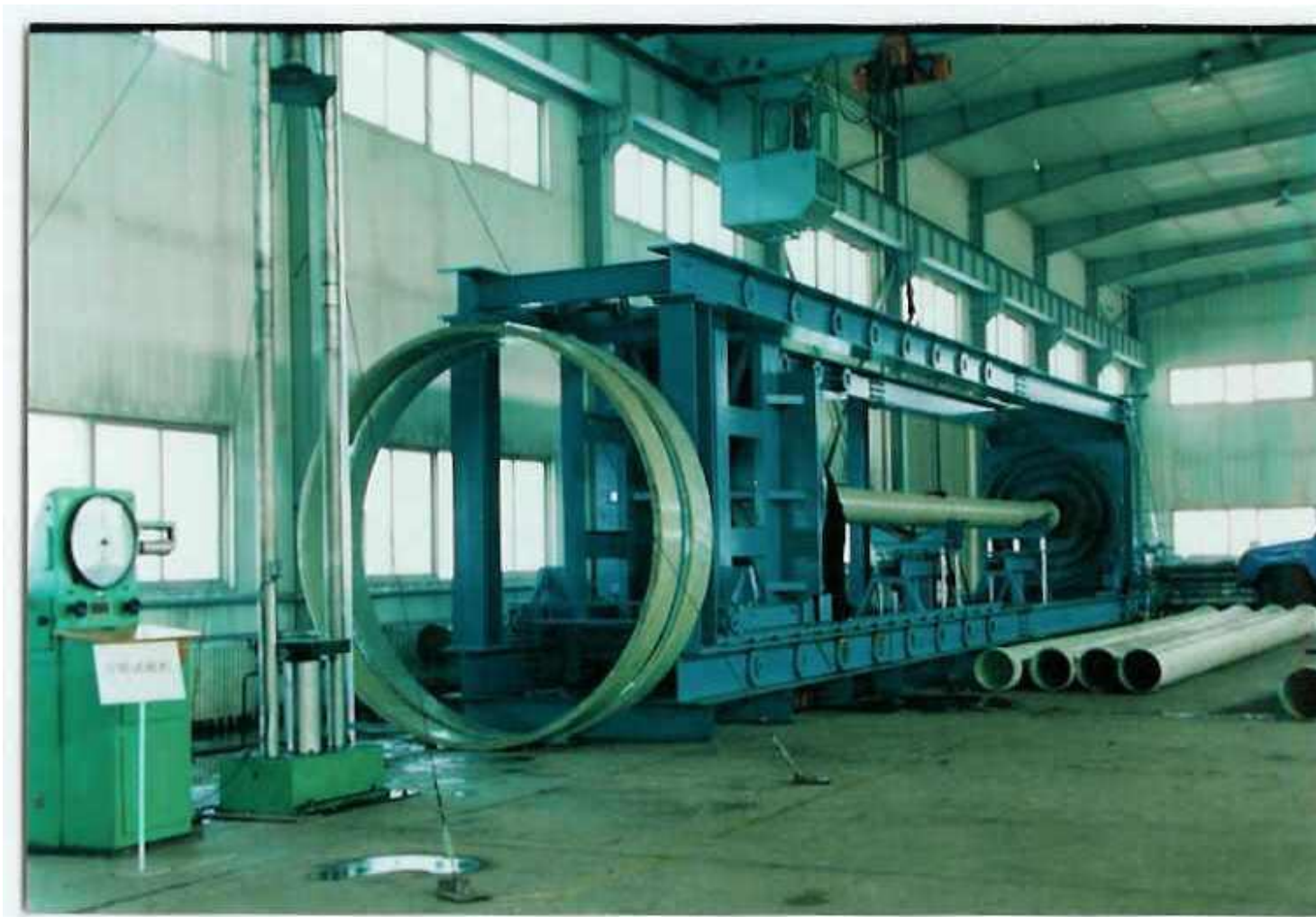
管道水压试验
