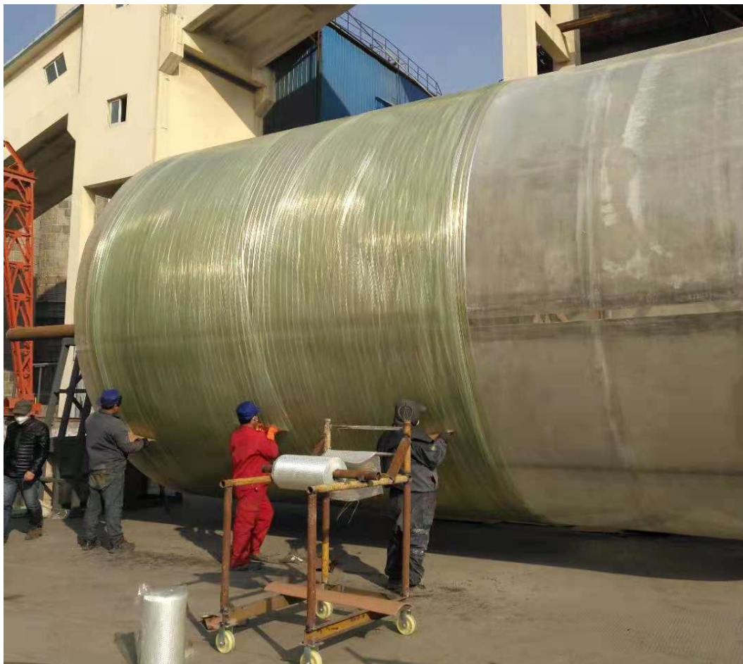
户外大型管道现场缠绕施工
